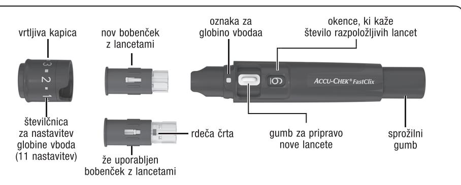
Bubenček z lancetami je pravilno vstavljen, če je v celoti nameščen v sprožilno napravo in izstopa spredaj le še rob (glejte ③).
